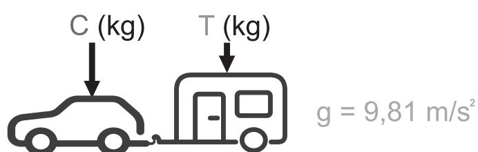
$$D \geq \frac{T \cdot C}{T+C} \cdot \frac{g}{1000} \text{ (kN)}$$
